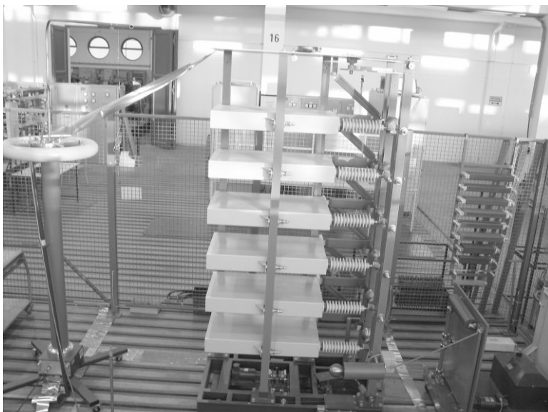
Abbildung: Stoßspannungsgenerator zur Erzeugung von Blitzstoß- und Schaltstoßspannungen bis 600kV
