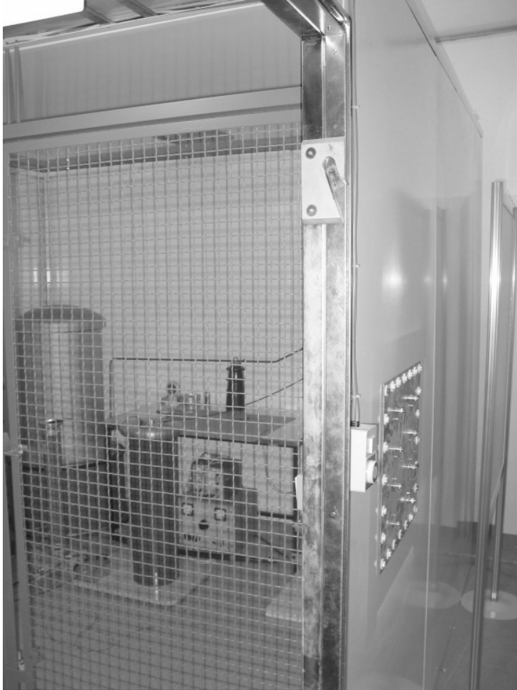
Abbildung: Geschirmte Messkabine zur Teilentladungs- und Verlustfaktormessung
